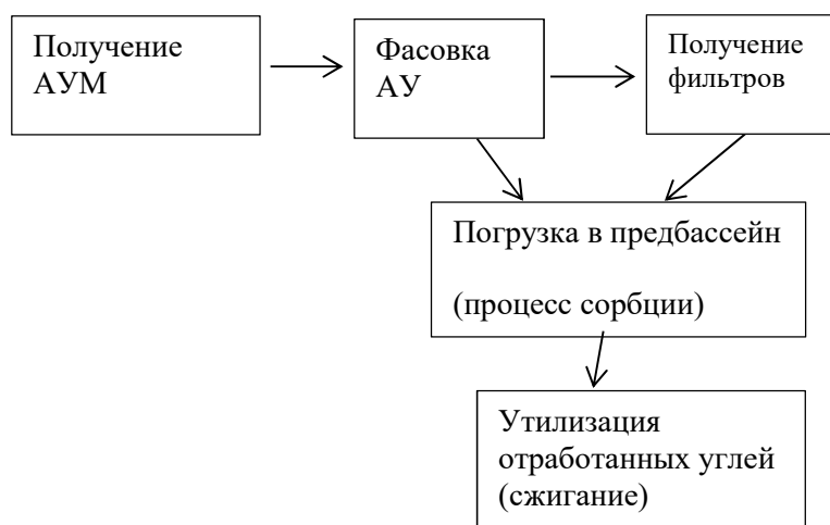
Рисунок 4.3 – Принципиальная схема очистки водоема от примесей ионов исследованных металлов.
